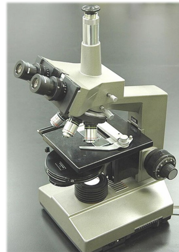
生物学などで一般的に使われる 位相差顕微鏡
