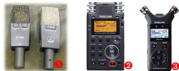
リニアPCMレコーダーは、非圧縮の「リニアPCM形式」で高音質の録音ができるデジタルレコーダー。通常のICレコーダーはMP3などの圧縮方式のため、データ容量を節約できる反面、音質はリニアPCMに劣ります。
